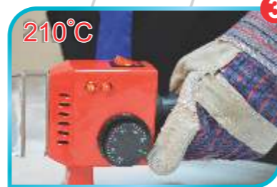
3 دستگاه را روی ۲۱۰ درجه تنظیم می کنیم
